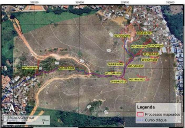
Figura 2 – Região de intervenção com mapeamento dos processos geológicos do estudo – Vista da Serra, Colatina/ES
